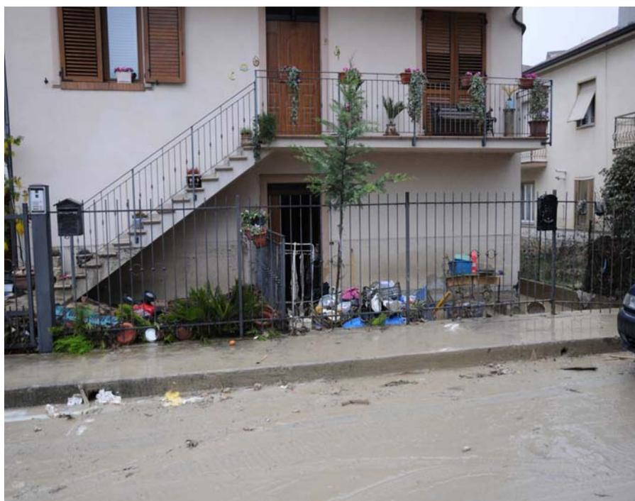
**Figura 64:** Fiume Ete Morto - Casette d'Ete - Edifici alluvionati - Sono evidenti le tracce del livello raggiunto dalle acque che ha superato il metro d'altezza allagando, oltre ai piani interrati, anche i piani terra delle abitazioni
