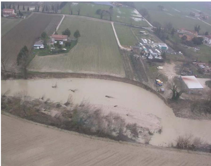
**Figura 84:** Fiume Musone - Estesa erosione della sponda sinistra in prossimità di un insediamento agricolo
