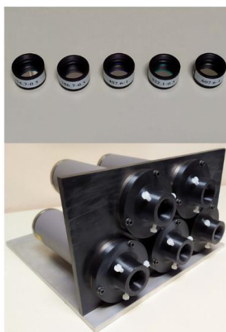
Fig. 9 A sinistra è mostrato il profilo verticale medio del backscatter coefficient degli aerosol misurato dal RL ARCADE nel Dicembre 2019. A destra c'è un dettaglio del nuovo Raman lidar multi-wavelength in costruzione presso i laboratori del CETEMPS: filtri interferenziali (in alto) e couplers montati sull'housing dei fotomoltiplicatori (in basso).
